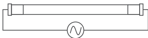
1灯式 両側給電の配線図
