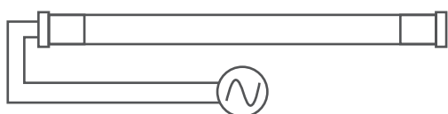
■ 1灯式 片側給電の配線図
