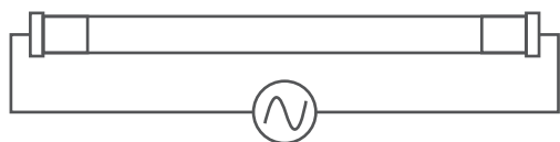
■ 1灯式 両側給電の配線図
